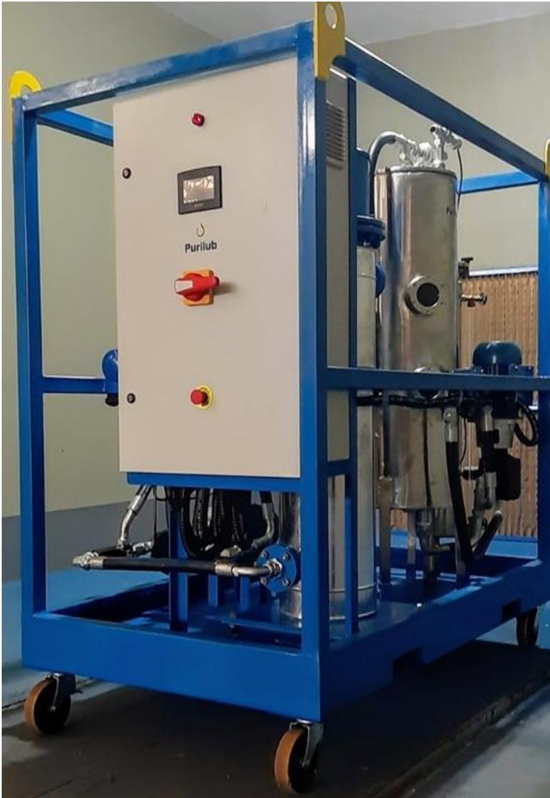
Consegue-se, com facilidade, redução de 400ppm para 20ppm de água!
